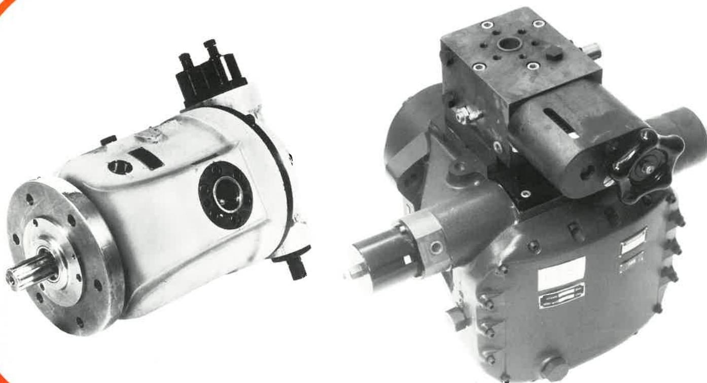
Dans ce type de pompes, la variation du débit est obtenue par la variation de l'inclinaison du bloc-cylindre ; le distributeur étant monté dans une cage oscillante, articulée sur 2 tourillons dans lesquels sont ménagés les orifices d'aspiration et de refoulement. Un joint de cardan relie le rotor d'entraînement des biellettes au bloc-cylindre.
