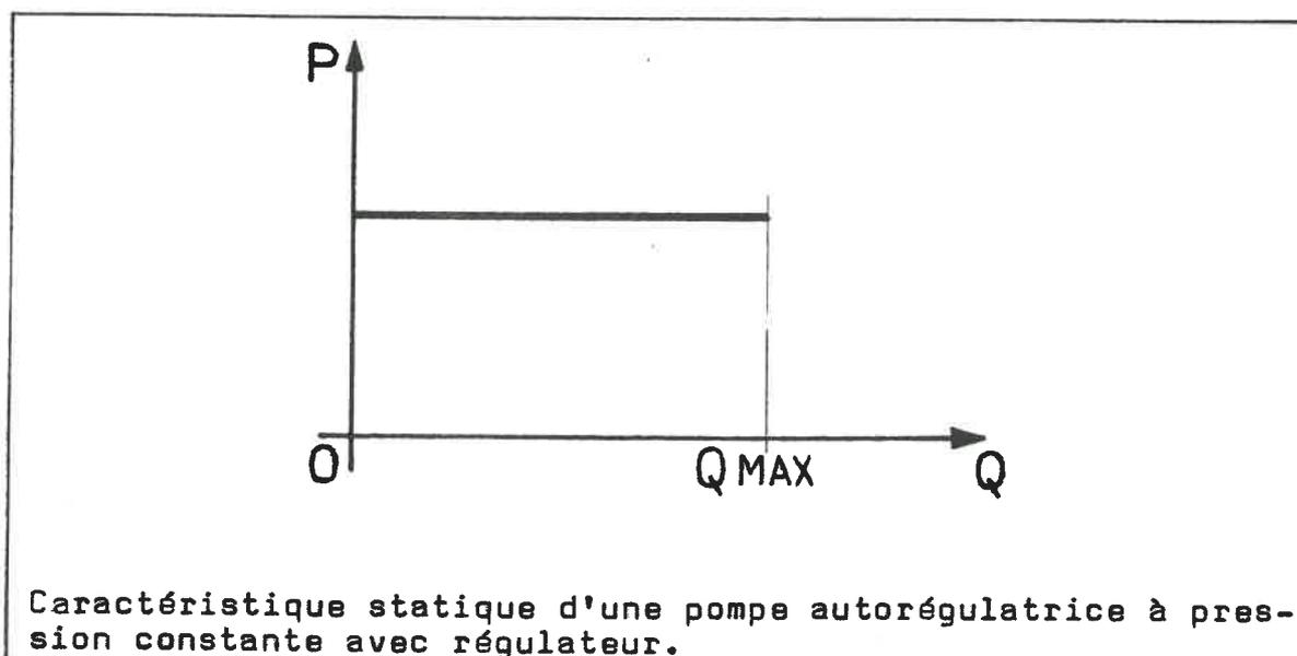
Caractéristique statique d'une pompe autorégulatrice à pression constante avec régulateur.
