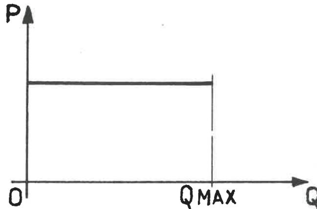
Caractéristique statique d'une pompe autorégulatrice à pression constante avec bloc de régulation
