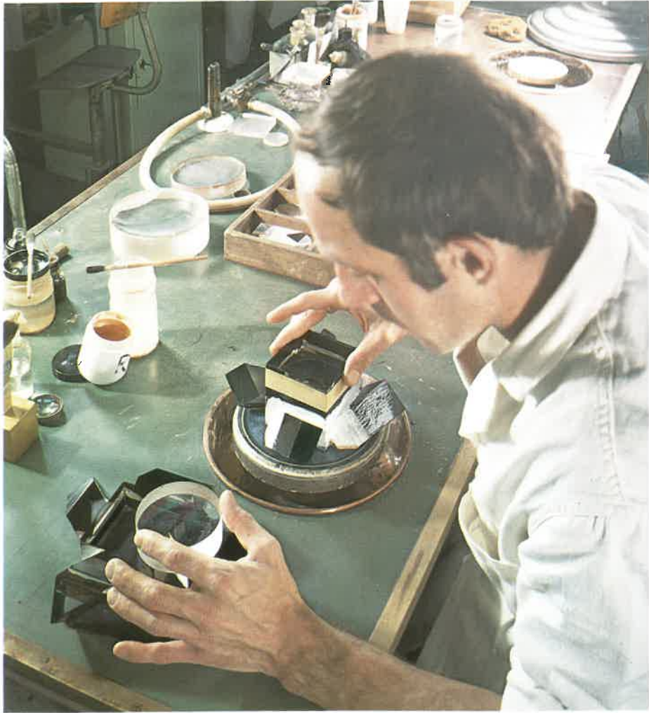
Polissage de prismes de très haute précision avec contrôles successifs en cours d'exécution.
